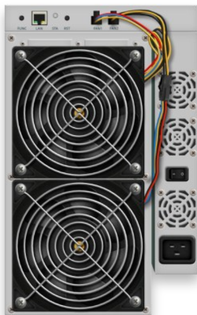
Obrázok 24 Model AvalonMiner 1246 s maximálnym hash rate 90Th/s pri spotrebe energie 3420W. Váha tohto zariadenia je 12,8kg. [37]
