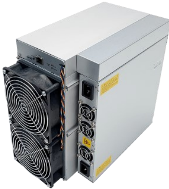
Obrázok 26 Model Bitmain Antminer S19 Pro (110Th) s maximálnym hash rate 110Th/s pri spotrebe 3250W. Váha tohto zariadenia je 13,2kg. Je jedným z najvýkonnejších na trhu. [39]
