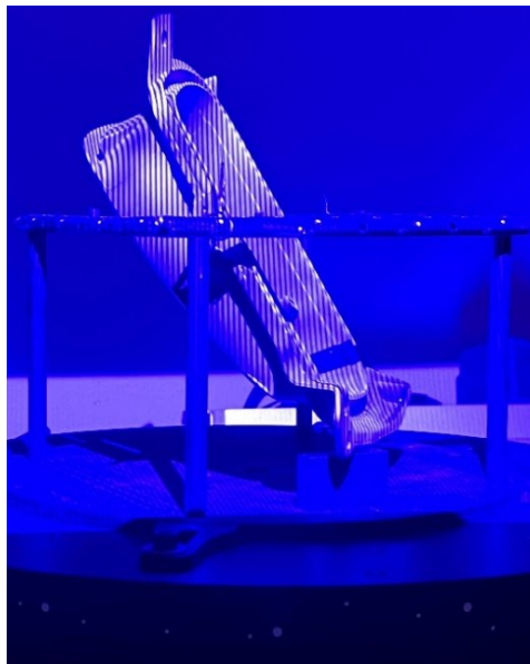
Obrázek 49 První způsob ustavení dílu při skenování v referenčním rámečku – vlastní zdroj
