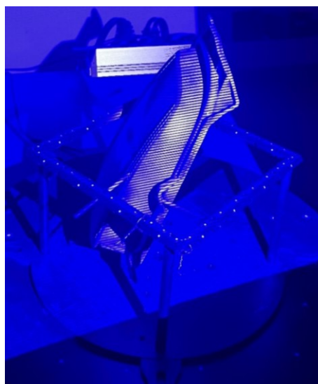
Obrázek 51 Druhý způsob ustavení dílu při skenování v referenčním rámečku – vlastní zdroj
