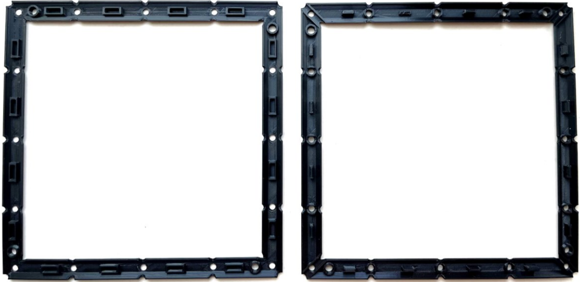
Obrázek 44 Části přípravku vyrobené pomocí 3D tisku – vlastní zdroj
