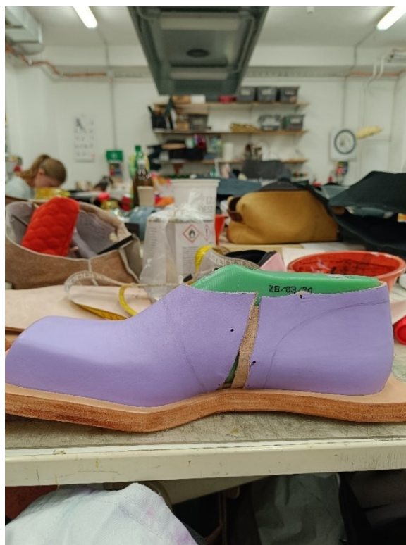
Obrázok 37 fáza orezania zvršku (vlastný archív)
