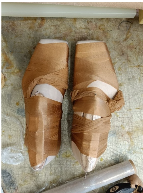
Obrázok 34 proces napínania zvršku (vlastný archív)
