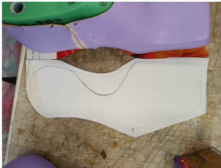
Obrázok 36 šablóna pre rámeček a podošev (vlastný archív)
