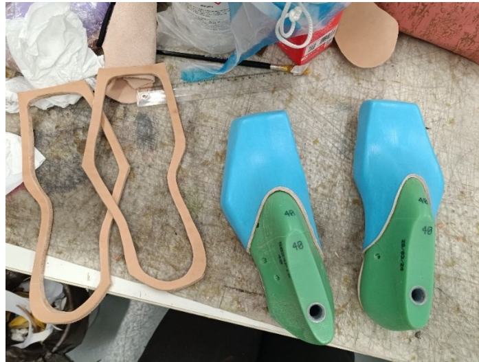
Obrázok 43 príprava podošve a rámku (vlastný archív)
