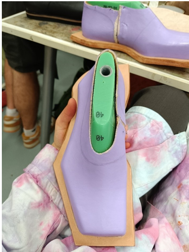
Obrázok 38 fáza orezania zvršku (vlastný archív)
