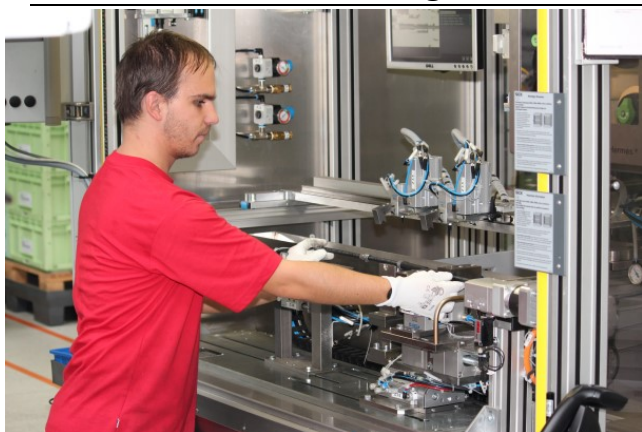
Obrázok 23 Test Brzdovej hadice 150bar (interný zdroj firmy)
