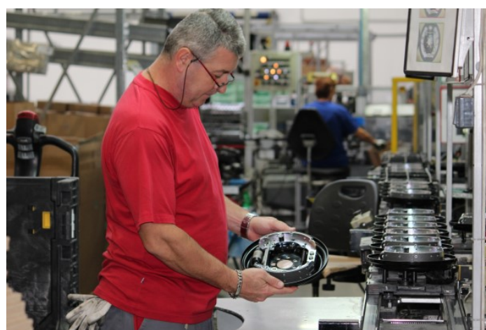
Obrázok 25 Bubnové brzdy - automatická linka montáže (interný zdroj firmy)
