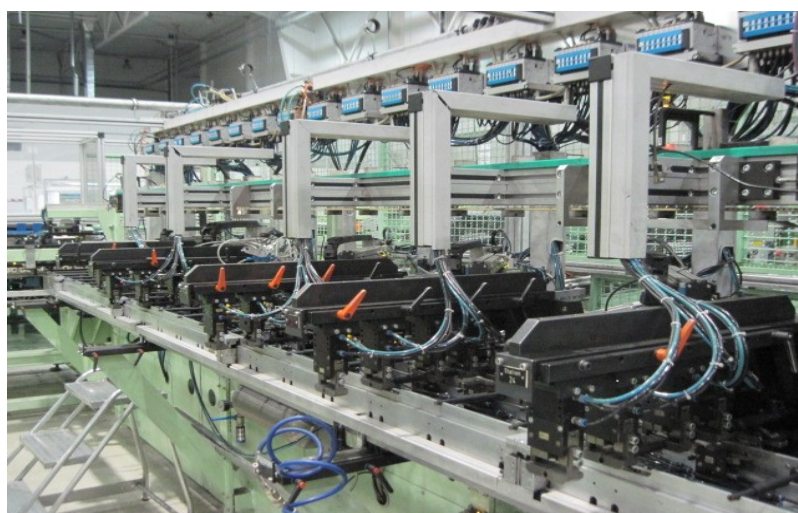
Obrázok 27 Brzdové hadice Audi – plnoautomatická montáž (interný zdroj firmy)
