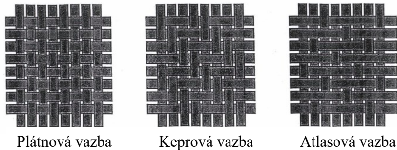
Obrázek 3 Druhy vazeb výztužných vláken [27]
