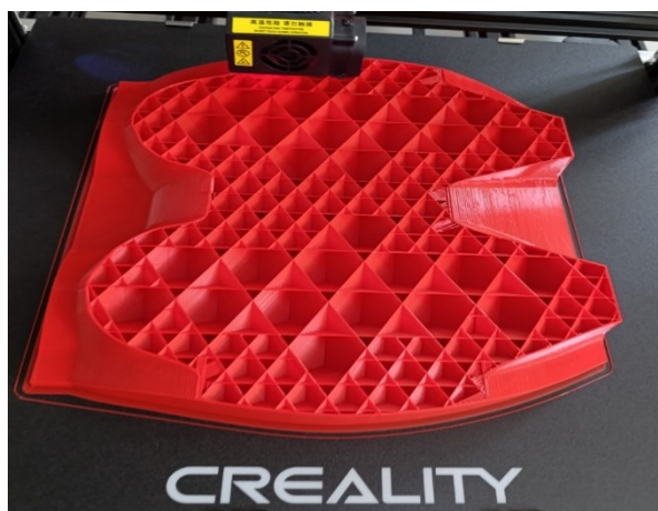
Obrázek 20 Model během tisku s viditelnou adaptivní výplní
