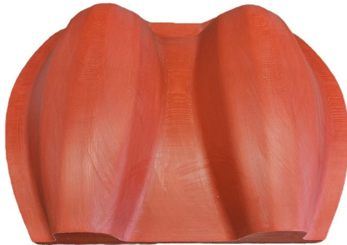
Obrázek 29 Nanesení separačního vosku
