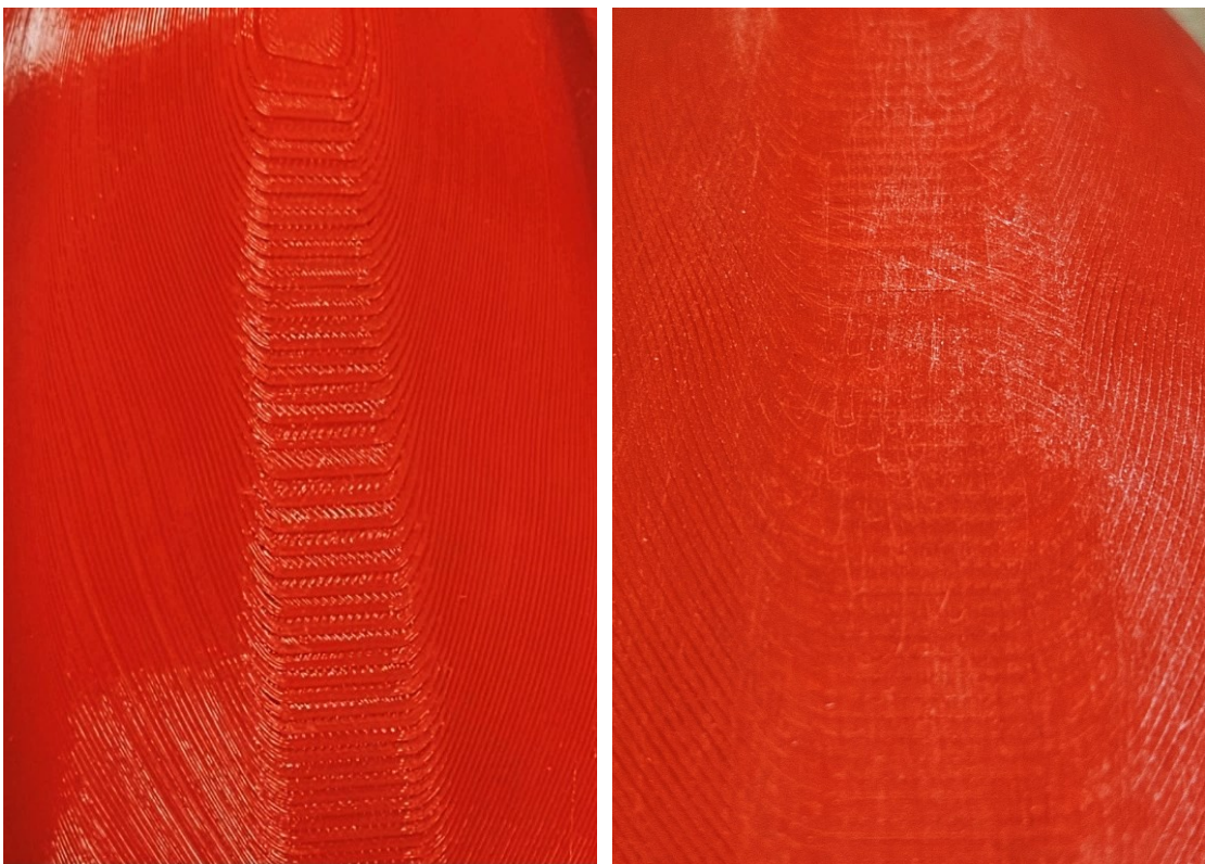
Obrázek 22 Porovnání povrchu modelu před broušením (vlevo) a po broušení (vpravo)
