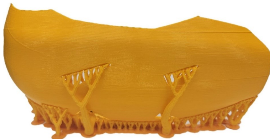
Obrázek 14 Tištěná prototypová součást s podporami
