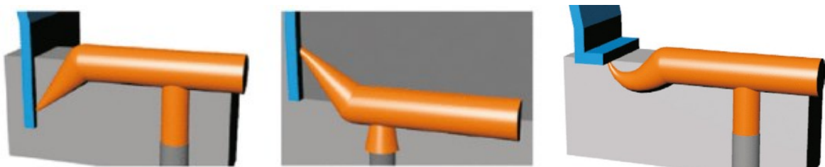
Obrázek 36 Tunelový (vlevo a uprostřed) a banánový (vpravo) vtok [28]
