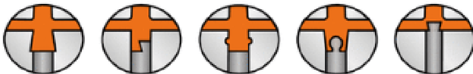
Obrázek 33 Používané tvary přídržovače vtoku [28]
