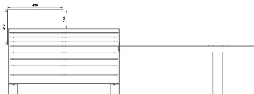
Obr. 70 Technický výkres střešky integrovaného koše v květináči
