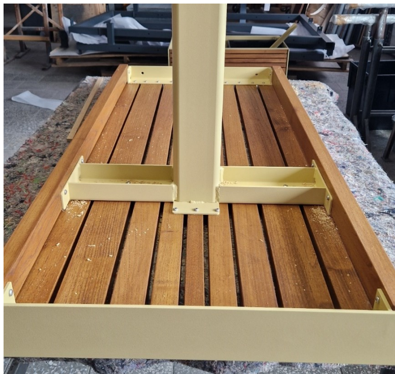
Obr. 59 Sešroubovaná lavička s nosnou konstrukcí
