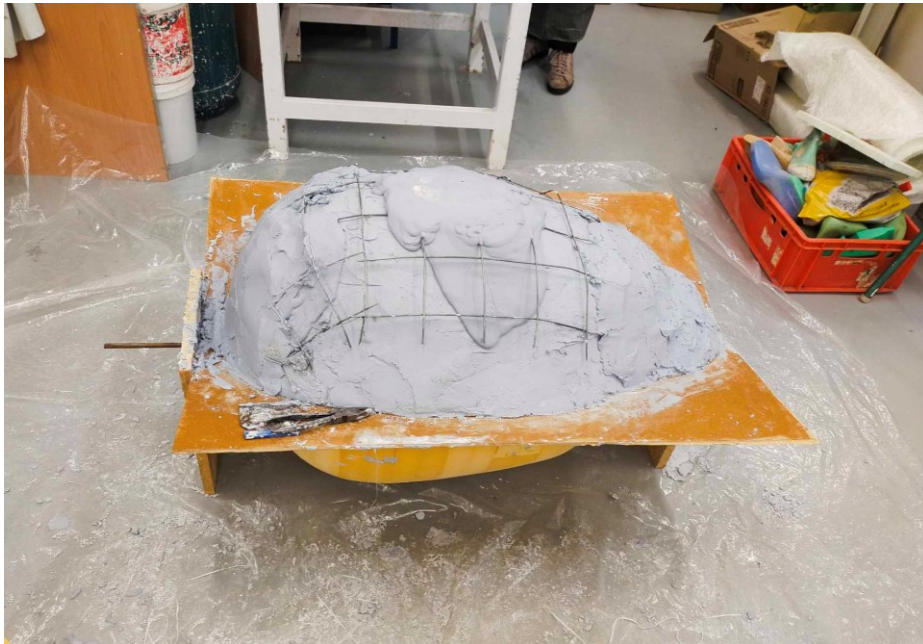
Obrázek 15: Zpevnění formy za pomoci kovová konstrukce
