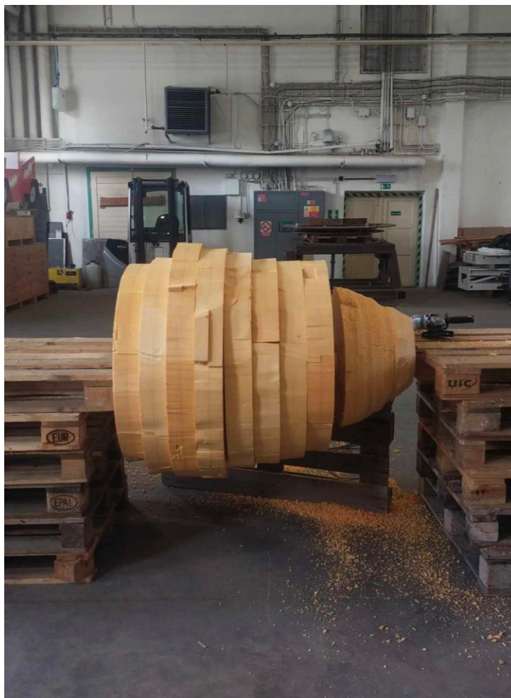
Obrázek 6: Hrubé tvarování úhlové brusky
