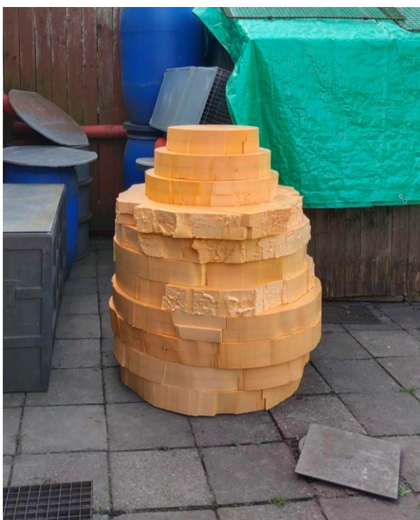
Obrázek 5: Seskládané a slepené díly k sobě
