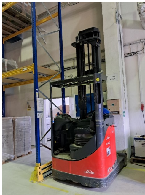
Obrázek 13 Retrak z paletového skladu (vlastní zpracování)
