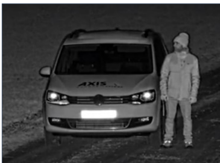
Obrázek 14 Vysoko-rychlostní otočná PTZ kamera AXIS Q6315-LE – obraz v noční době za využití infračervených diod [40]
