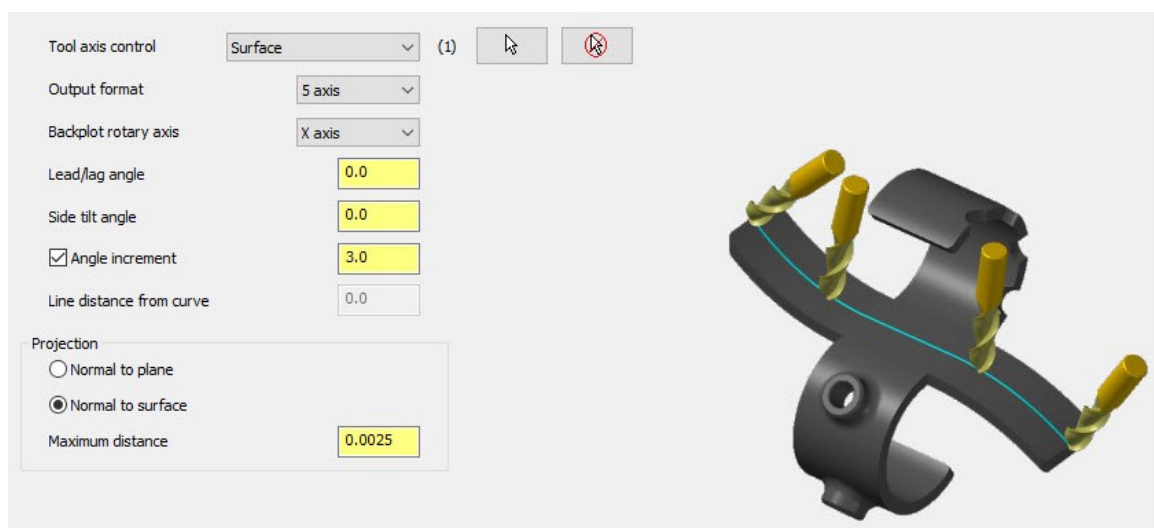
Obrázek 46 Parametry nastavení osy nástroje pro pětiosé frézování
