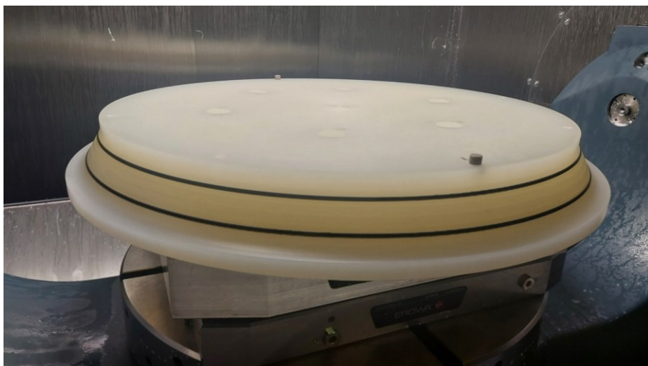
Obrázek 67 Druhá strana vakuového přípravku
