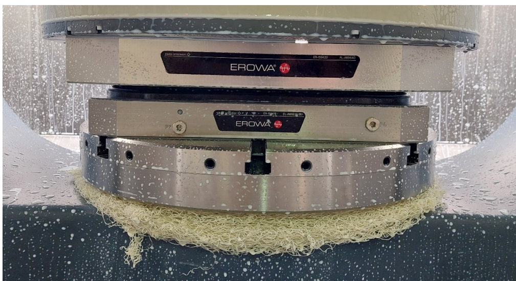
Obrázek 26 Namotané třísky kolem otočného stolu
