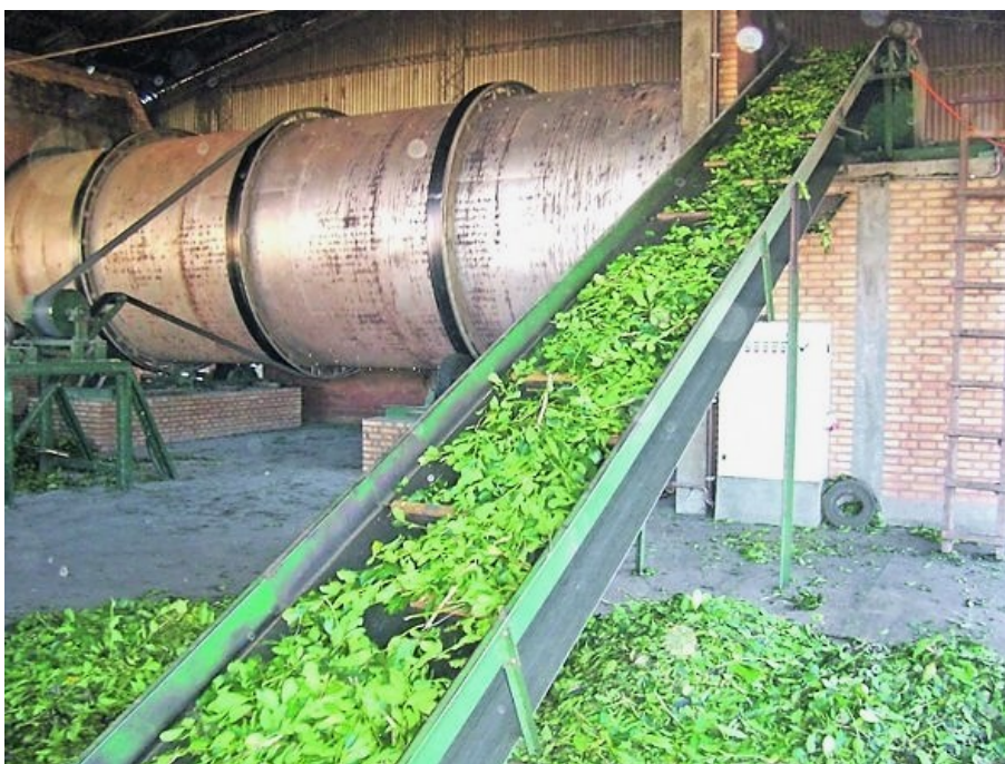
Obrázek 4 – Pásový dopravník a bubnová sušárna [3]
