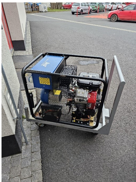
Elektrocentrála v kontejneru nouzového přežití. (vlastní tvorba, 2024)
