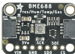
Obrázek 11. Senzor měření teploty, vlhkosti, tlaku a VOC plynů[55]
