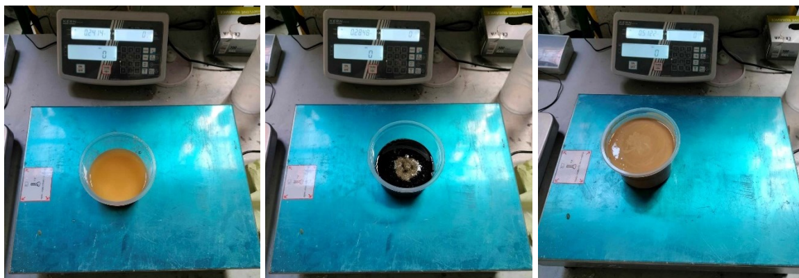
Obrázek 35, 36 a 37 Vlevo odvažování polyolu, uprostřed isokyanátu a vpravo smíchaná směs
