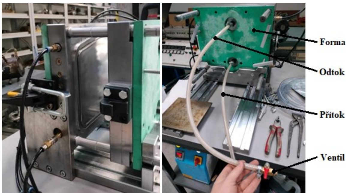
Obrázek 24 a 25 Vlevo dutina formy, vpravo forma zepředu
