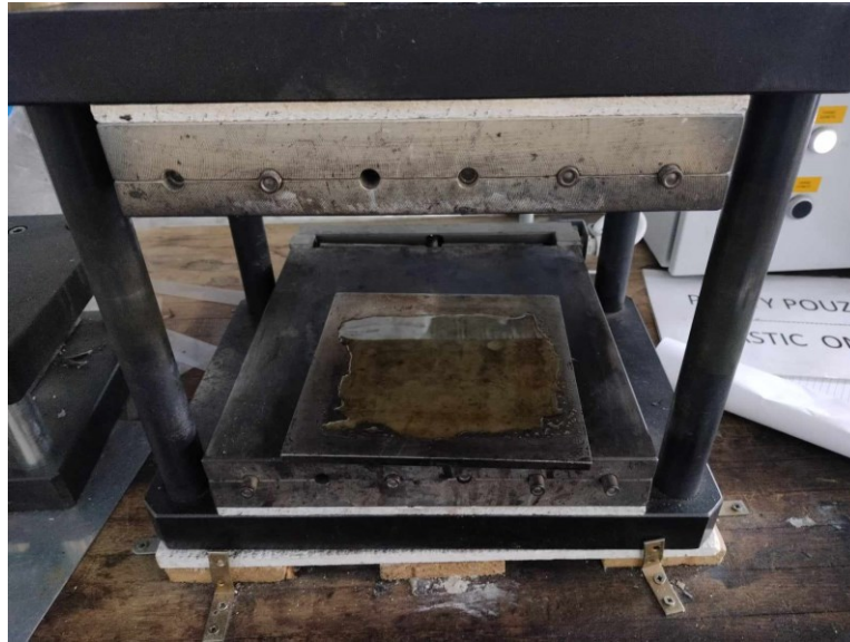
Obrázek 31 Měření doby dostatečného vytvrzení Elastolitu R8889/101 pro odformování
