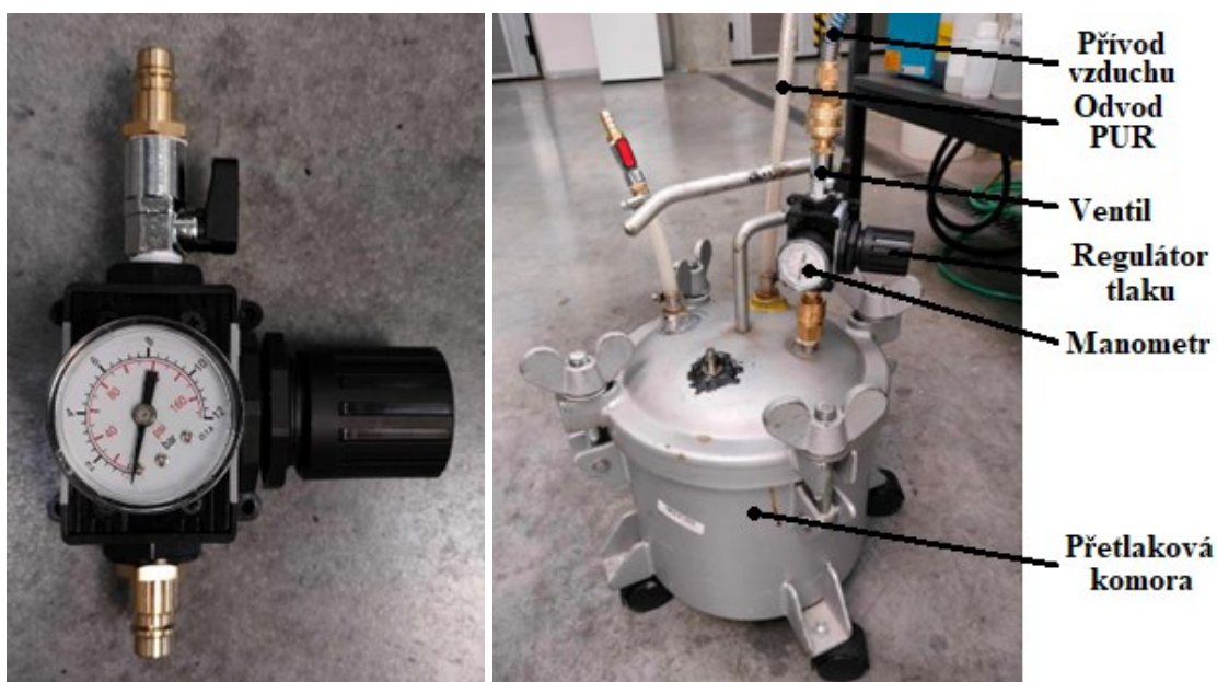
Obrázek 22 a 23 Vlevo regulátor tlaku s manometrem, vpravo zapojená přetlaková komora
