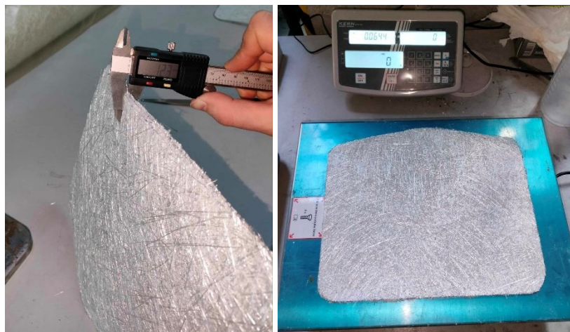
Obrázek 33 a 34 Kontrola rozměrů a hmotnosti spojených rohoží
