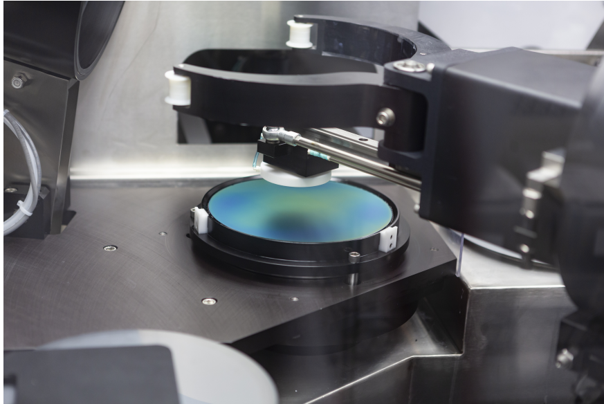
Obrázek 29 Leštění křemíkových desek (Interní zdroj společnosti)
