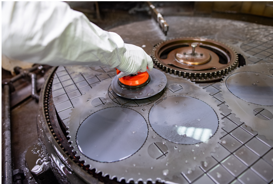
Obrázek 22 Lapování křemíkových desek (Interní zdroj společnosti)
