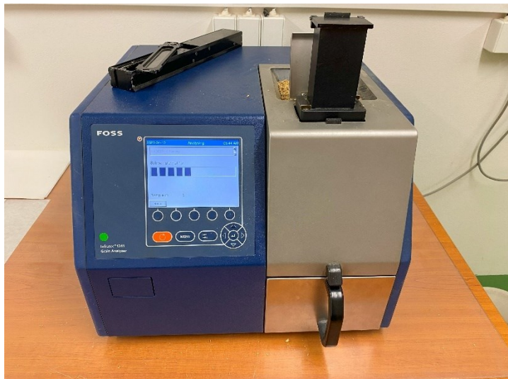
Přístroj na analýzu ječmene a sladu
