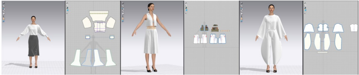
Obr. 16 – Odevy v programe CLO3D umiestnené na figuríne a strihy jednotlivých kúskov
