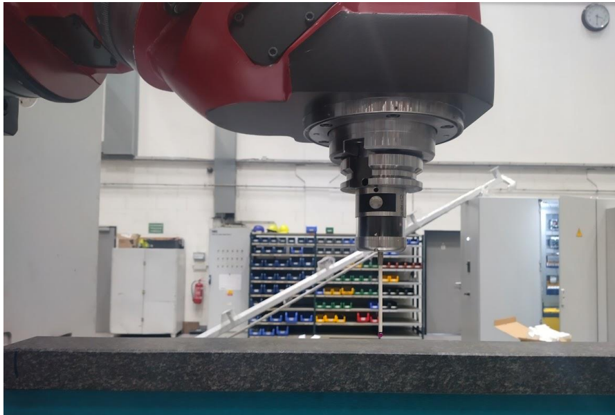
Obrázek 20. Obrobková sonda RMP60 na obráběcím stroji
