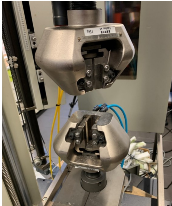
Obrázek 31 Speciální pneumatické čelisti
