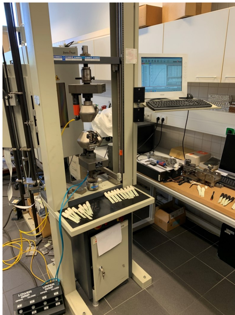
Obrázek 30 Univerzální trhací stroj Zwick/Roell 1456
