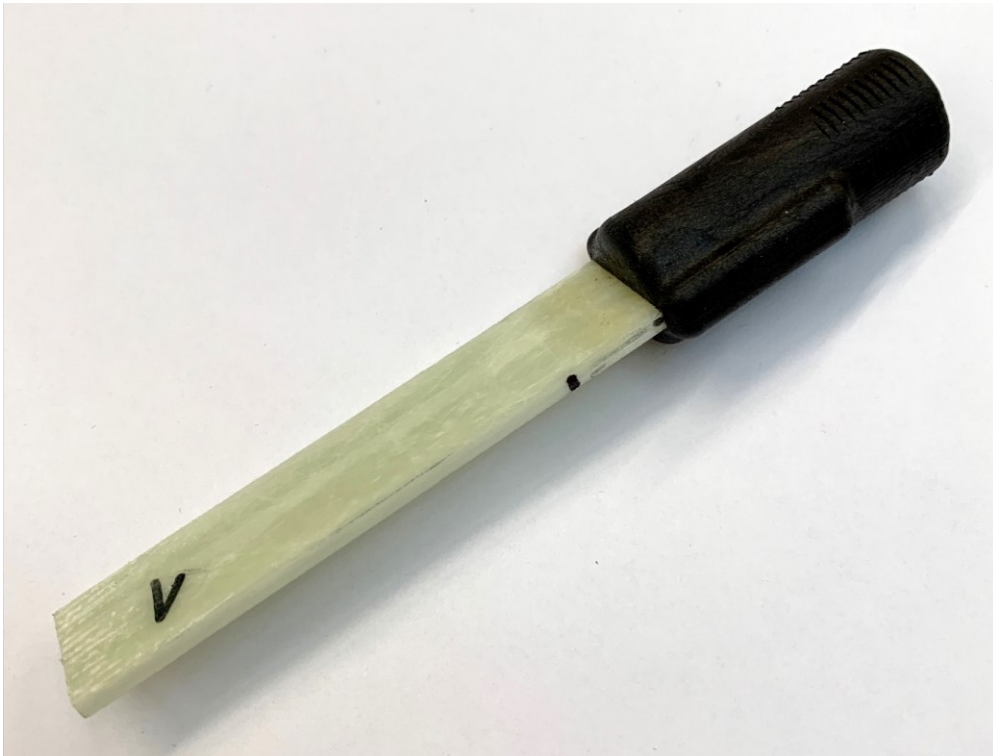
Obrázek 45 Vzorek zastříknutý PA66-GF35 s povrchovou úpravou plasmou 15 sekund po testování tahem
