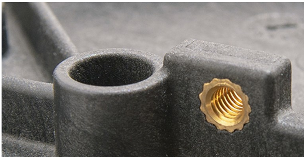
Obrázek 7 Insert z kovového materiálu zastříknutý polymerem [30]
