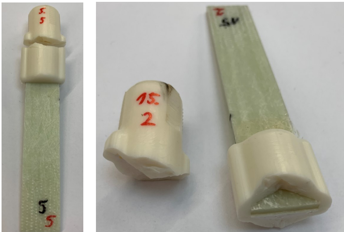
Obrázek 44 Vzorky zastříknuté PA66 s povrchovou úpravou plasmou 5 sekund (vlevo) a 15 sekund (vpravo) po testování tahem s přetrženou plastovou částí
