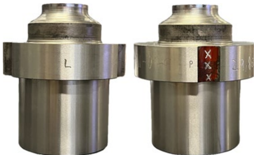
Obr. 31: Označení orientace levé (vlevo) a pravé (vpravo)
