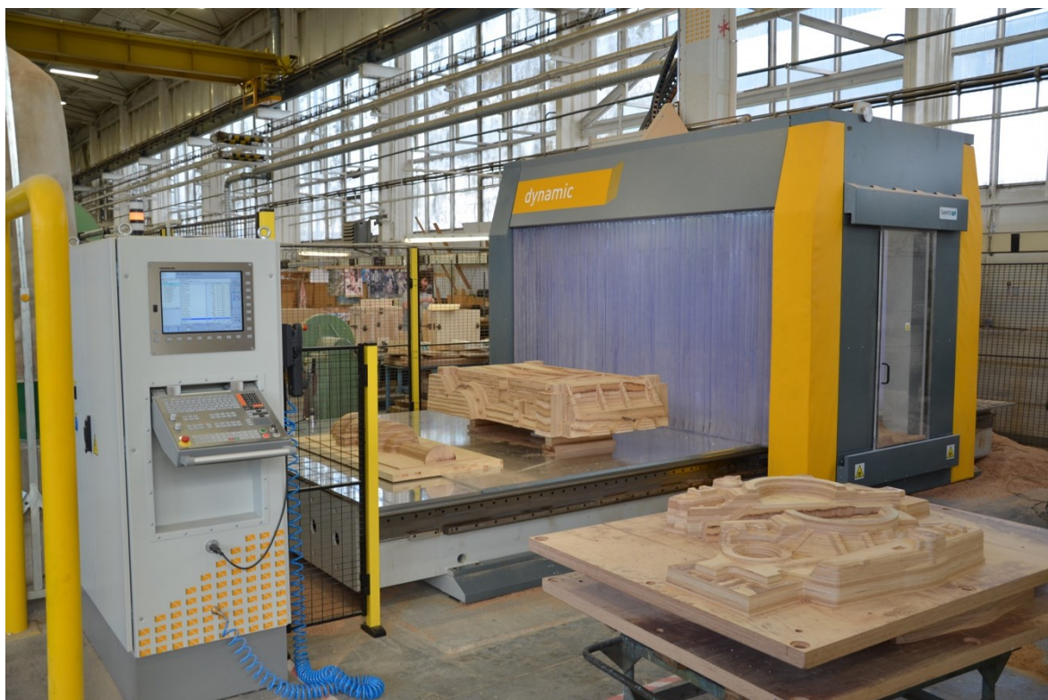
Obrázek 5. Výroba modelových zařízení
