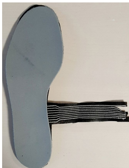
Obrázek č.10: Materiál EVA jako sendvičová ochranná spodní a vrchní vrstva stélky, uvnitř je stélka se senzory, vyšitými vodivými cestami a elektrodami.
