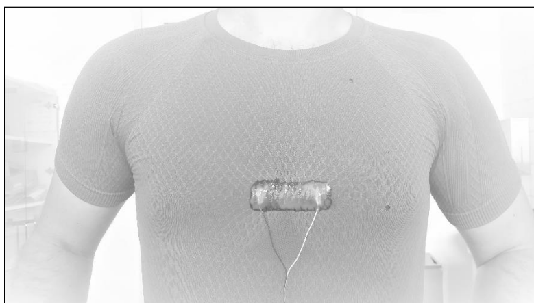
Obrázek č.12. Umístění jednoho senzoru na tričko pro praktickou aplikaci monitorování lidského dechu [foto autora].
