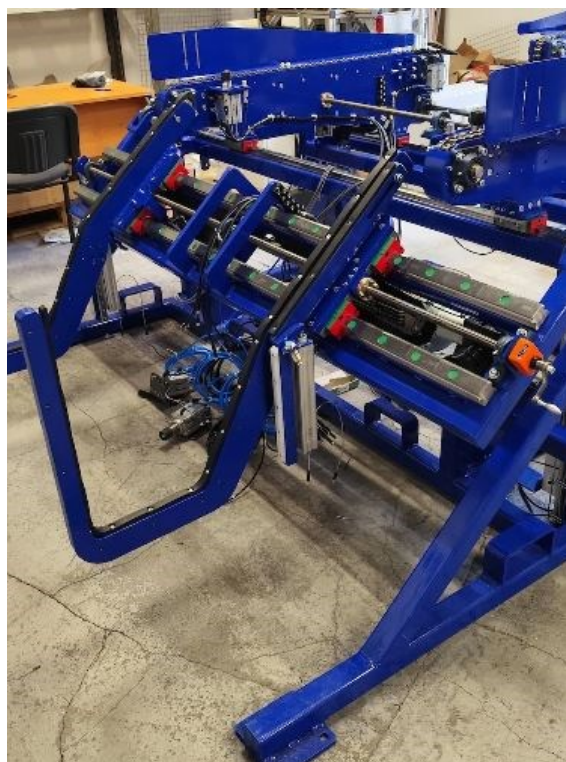
Obrázek 9 Automatizovaný vstupní dopravník
