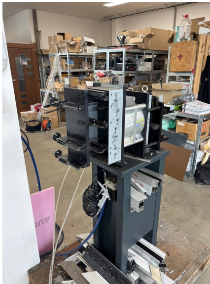
Obrázek 17 Vysekávací stanice ( vlastní zpracování )
