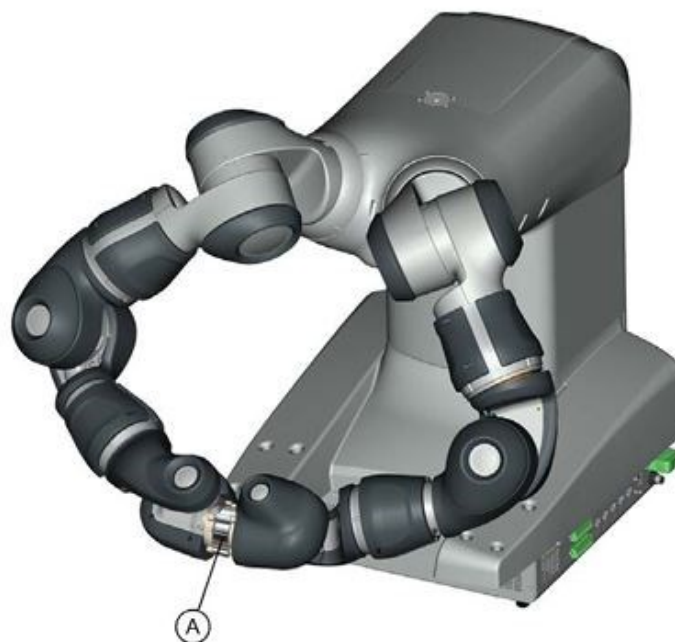
Obrázek 6. Kalibrace robota pomocí spojených paží [32]
