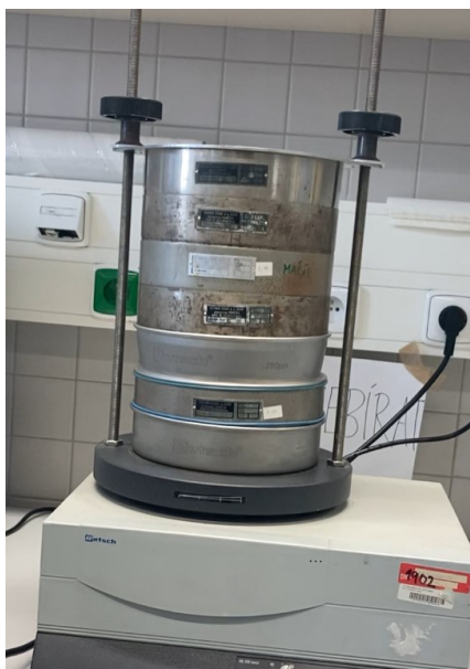
Obrázek 11. Průběh sítové analýzy
