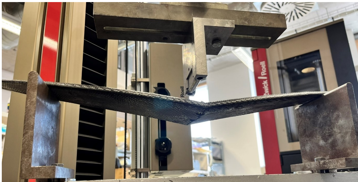
Obrázek 56 Zadní křídlo po zkoušce tříbodovým ohybem
