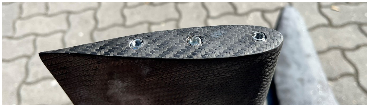
Obrázek 59 Závitové vložky v ostruze
