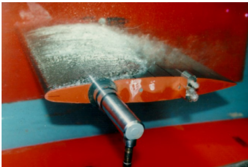
Obrázek 25 Testování hydrofoilu v kavitačním tunelu [31]
