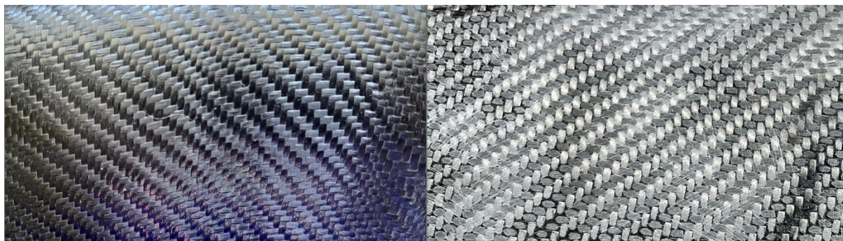
Obrázek 58 Porovnání povrchů před (vlevo) a po broušení
