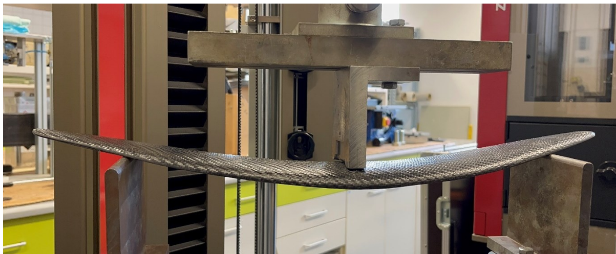
Obrázek 54 Zkouška tříbodovým ohybem
