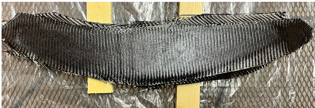
Obrázek 48 Spodní strana zadního křídla po laminování
