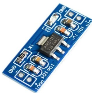
Obrázek 25 – Modul stabilizátoru napětí 12 V na 5 V [25]
