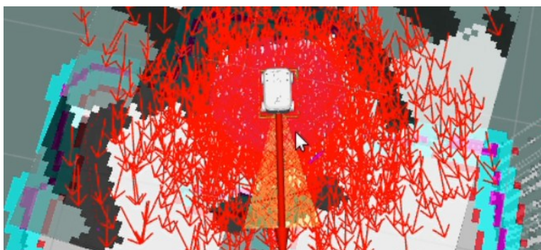
Obrázek 35 Počáteční poloha částí při AMCL
