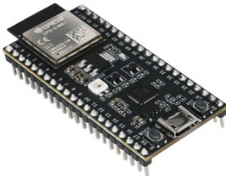
Obrázek 13: Vývojová deska ESP32-S2-DevKitM-1 [42]
