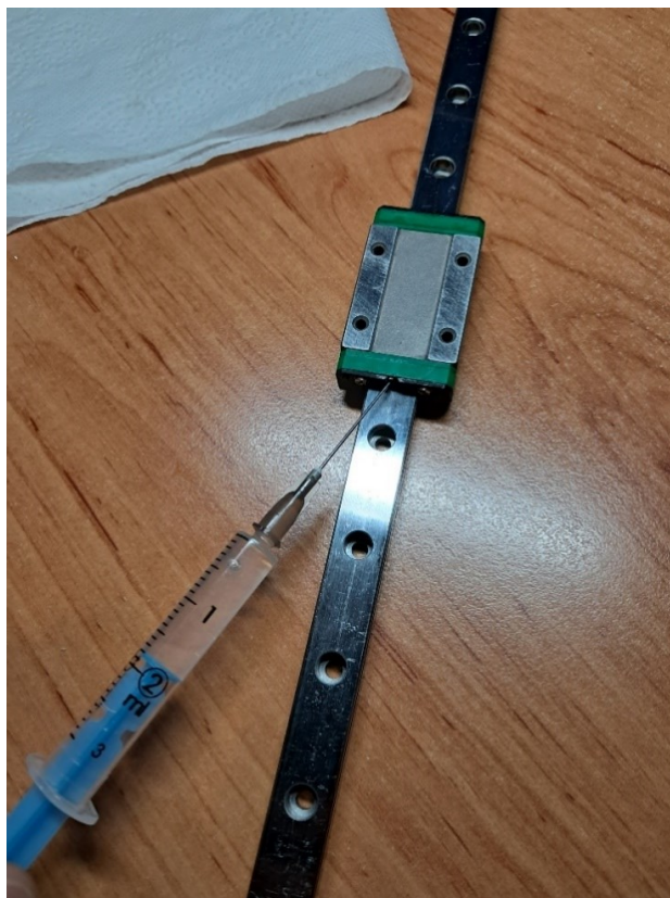
Obrázek 35: Mazání lineárního ložiska
