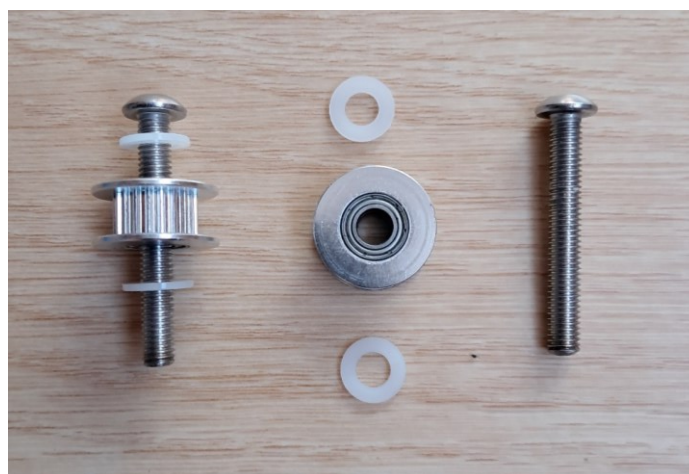
Obrázek 42: Kladka mezi polyamidovými podložkami
