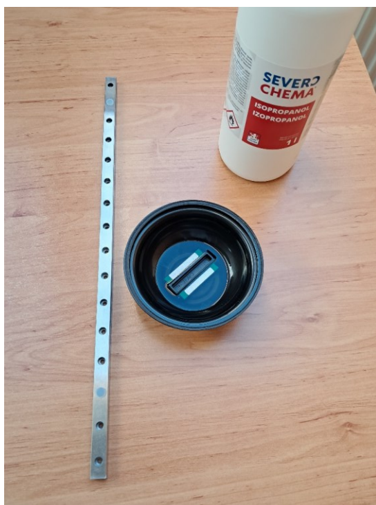
Obrázek 34: Čištění lineárního ložiska
