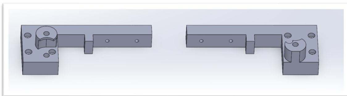
Obrázek 40: Pohyblivé díly pro uchycení kladek GT2 a osy X
