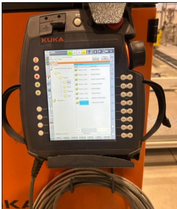
Obrázek 17: Ovládací panel robotu Kuka uspořádaný „na výšku“ [vlastní zdroj]
