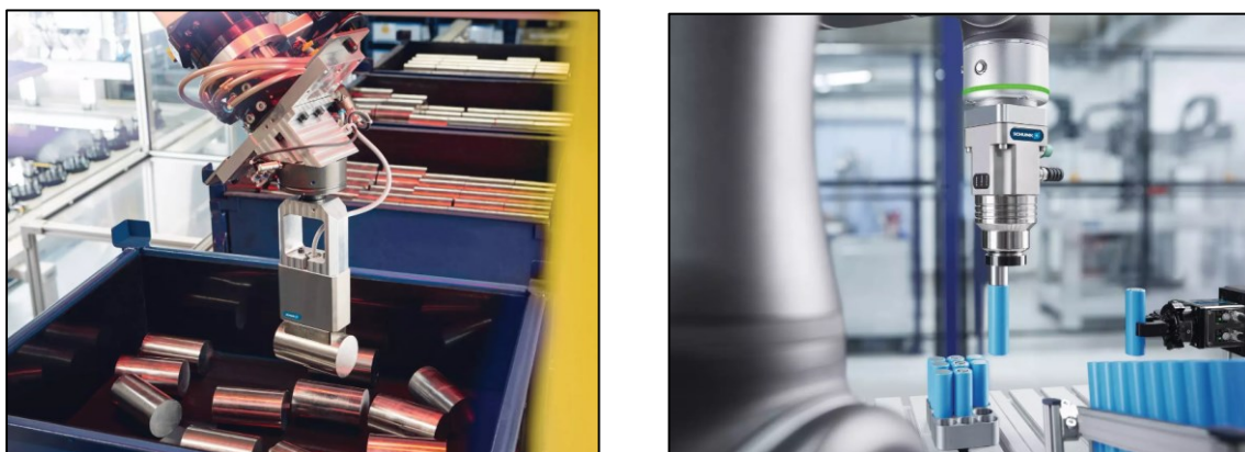
Obrázek 10: Vlevo pasivní a vpravo aktivní magnetický úchopný efektor [18]
