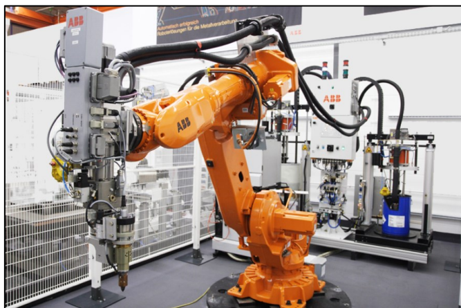
Obrázek 14: Robot s lepící hlavicí [21]
