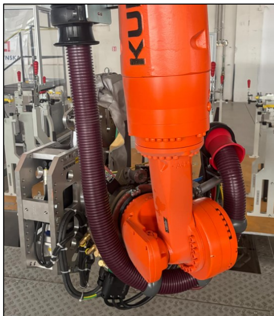
Obrázek 74: Natáhnutí svazku kabelů o pátou osu robotu
