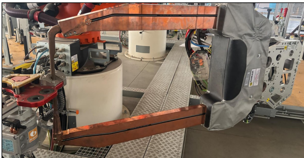
Obrázek 67: Svařovací kleště ve frézovací pozici
