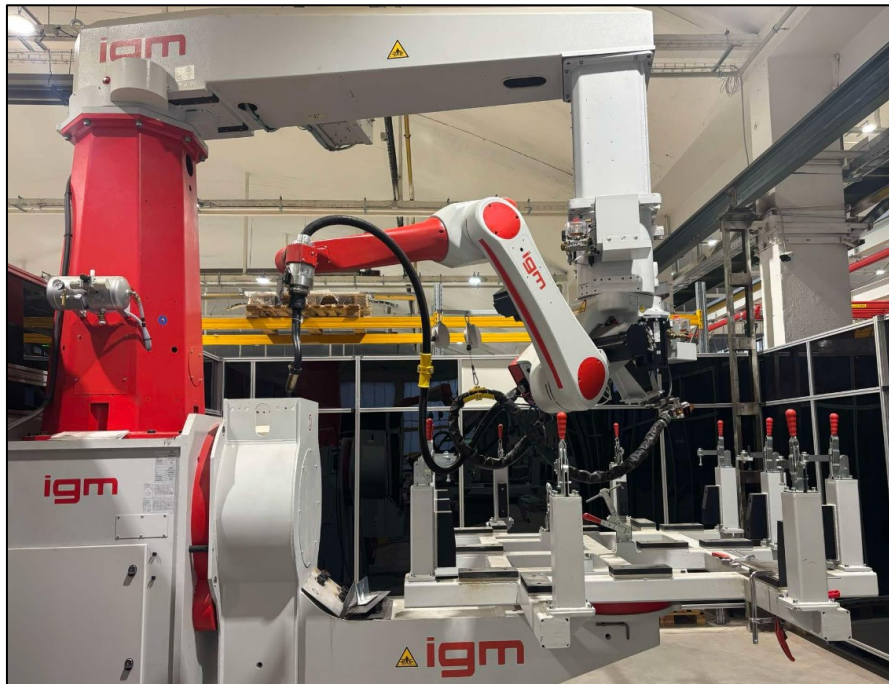
Obrázek 25: Robotická svařovací buňka od společnosti IGM. [vlastní zdroj]
