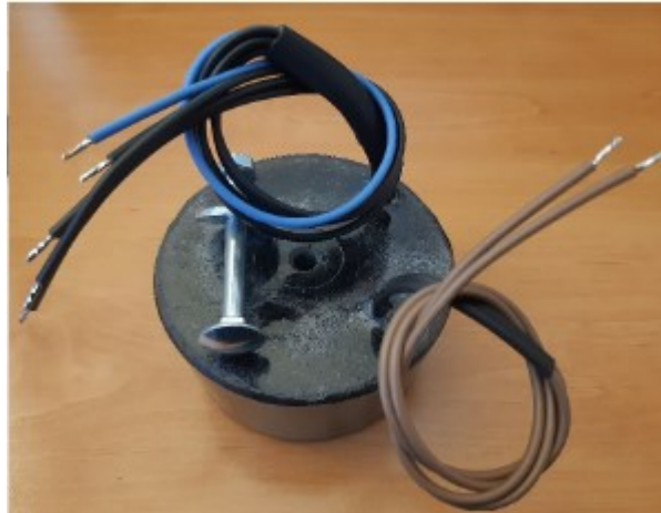
Obrázok 4 Toroidný transformátor o výkonu 80 VA [5]
