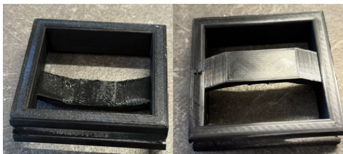
Obrázok 13 Vytlačené teleso rámu cievky po 3D tlači
