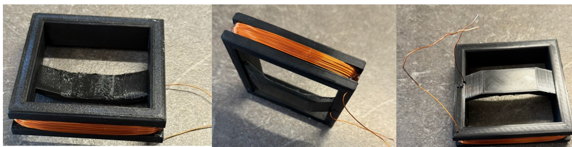
Obrázok 14 Navinutý medený vodič na telo cievky
