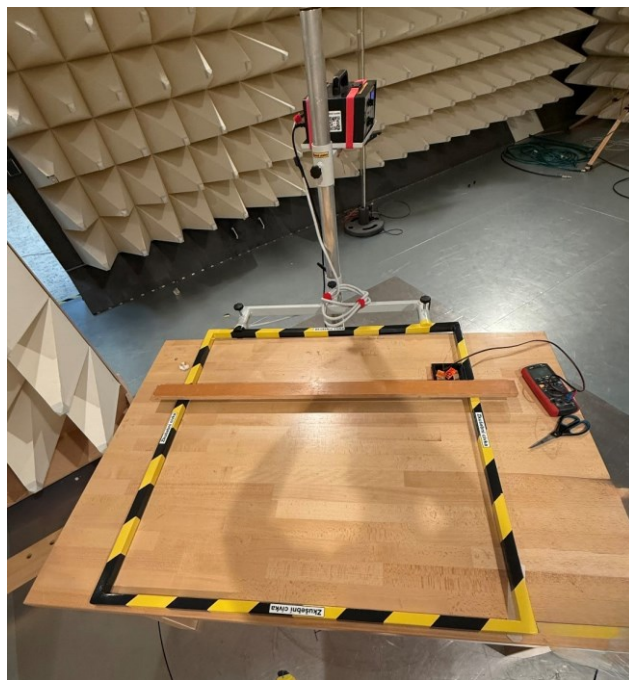
Obrázok 23 Pripravená rámová skúšobná cievka generátora na meranie
