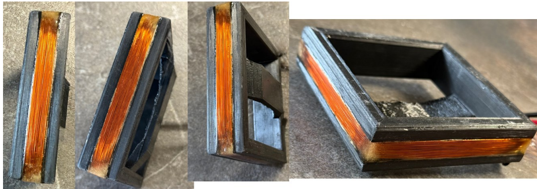
Obrázok 17 Zalakovaný povrch cievky ochranným lakom
