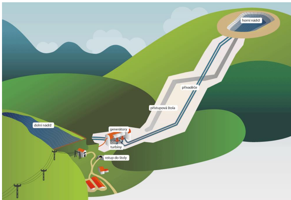
Obrázek 8 Princip fungování přečerpávací elektrárny
