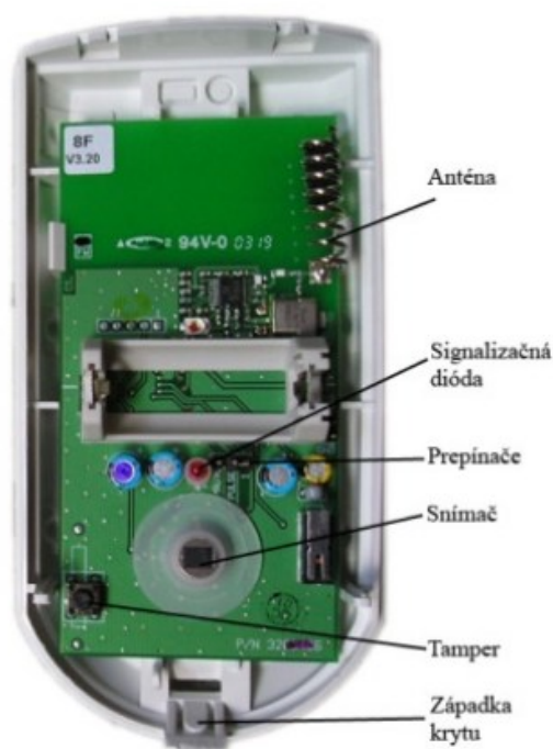
Obrázok 10 Konštrukcia PIR detektora
