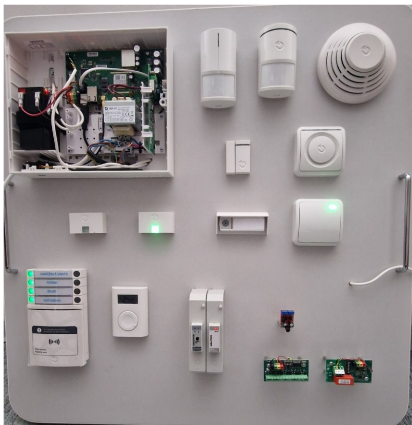
Obrázok 22 Zabezpečovacia ústredňa so zapojenými periférnymi zariadeniami
