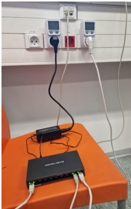
Obrázok 21 Zapojenie merača, switchu a kamery
