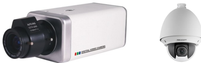
Obrázek 14 Ukázka kamer: vlevo kamera Box, vpravo kamera Dome
