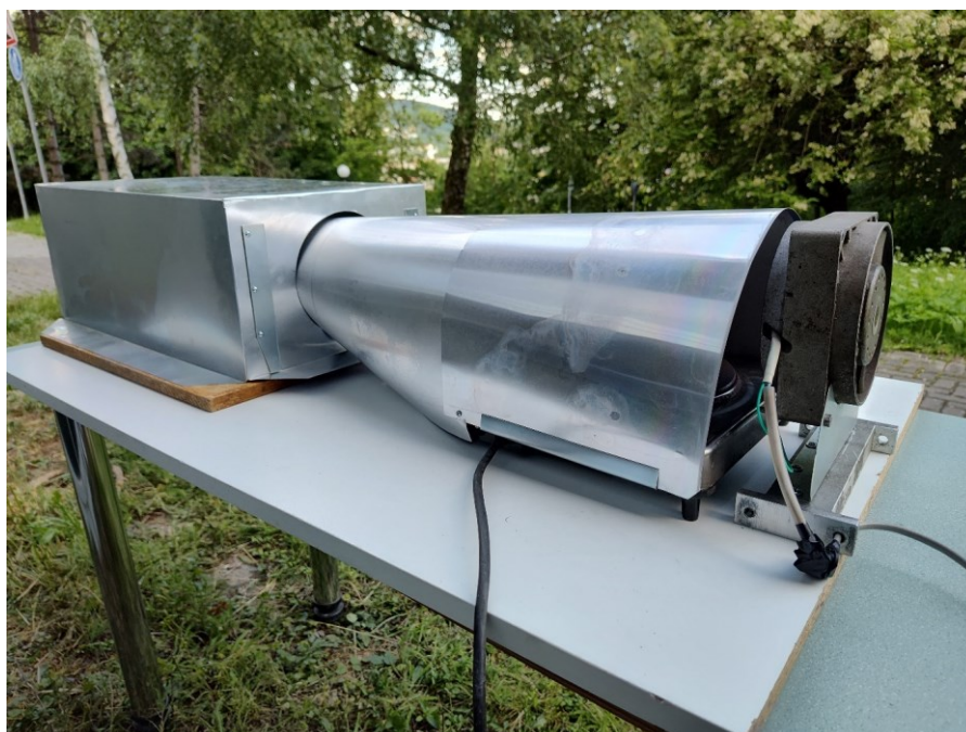
Obrázek 32 Testovací sestava pro měření reakční doby hlásičů
