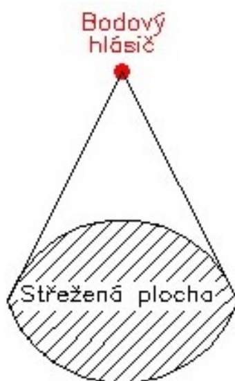
Obrázek 1 Snímací charakteristika bodových hlásičů požáru
