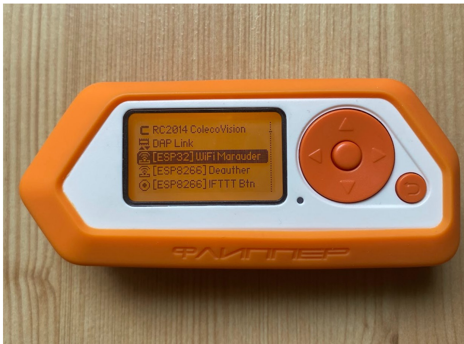
Obrázek 8 - Flipper zero s aplikací wifi marauder
