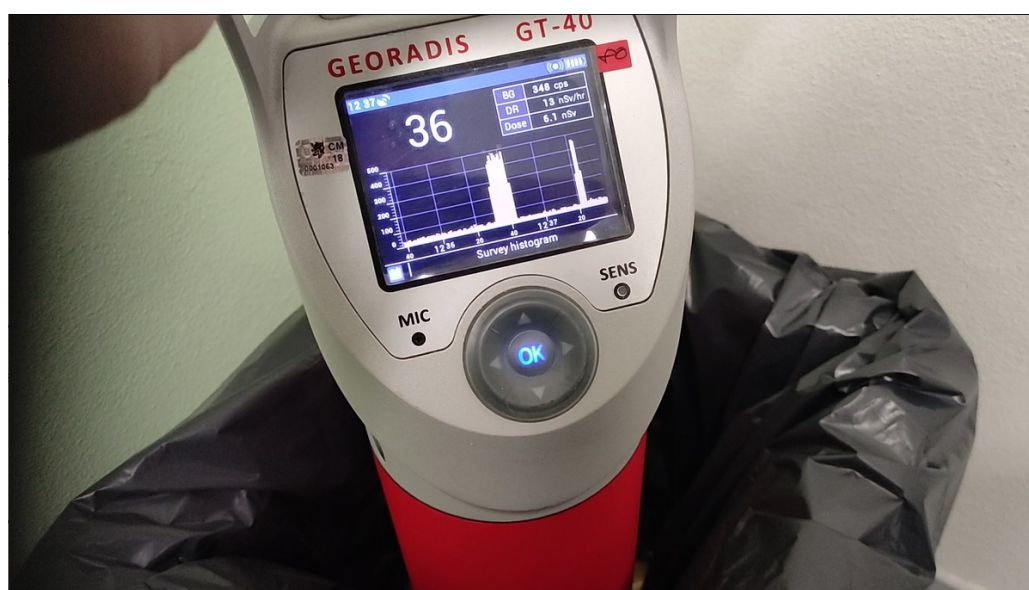
Obrázek 25. Měření stavebních materiálů
