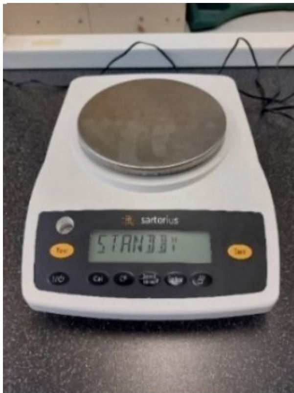
Obrázek 23. Laboratorní váha Entris 822 – 1S
