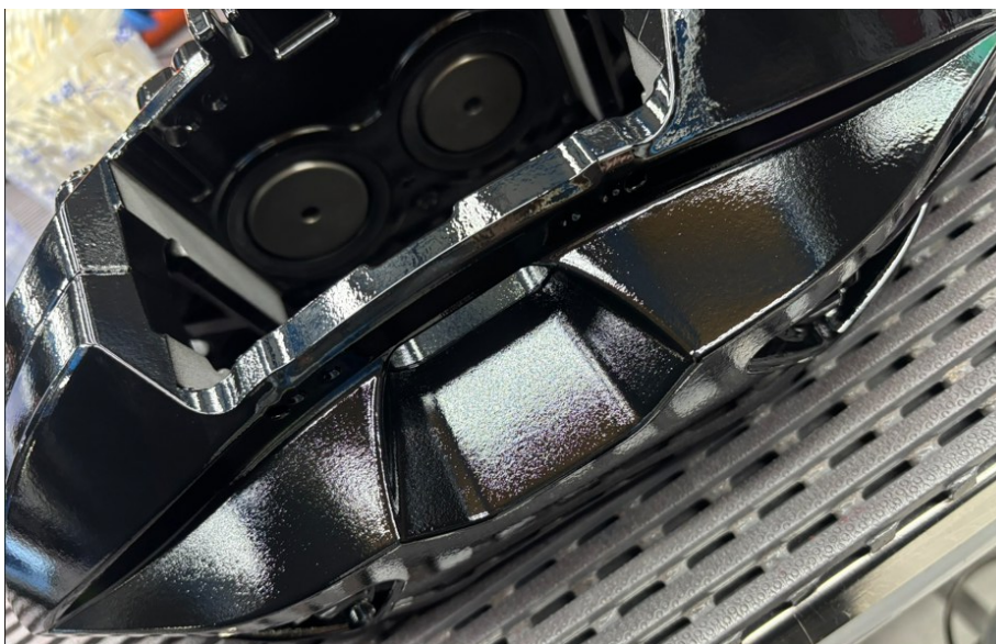
Obrázek 19 Nedolak způsobený zaneseným rozprašovačem
