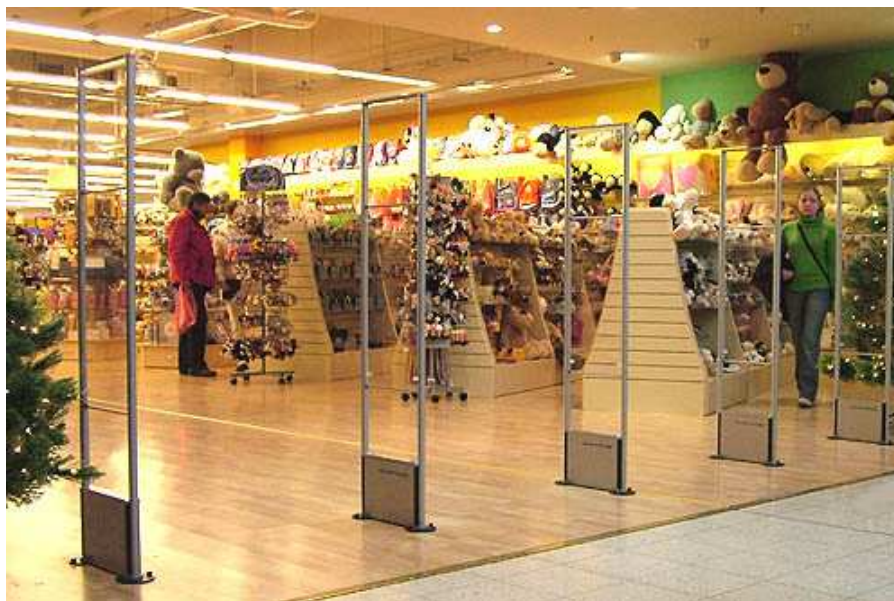
Obr. 3. Ukázka umístění antén u vchodu do prodejny
