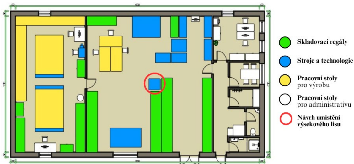
Obrázek 16 Layout s návrhem umístěním výsekového lisu
