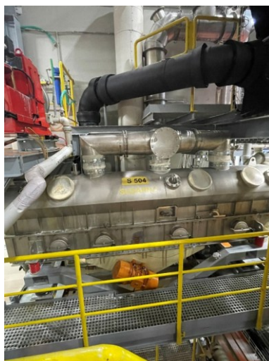
Obrázek 12 Vibrofluidní sušárna (Vlastní zpracování)
