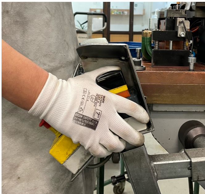
Obrázek 22 Přiložení palce na senzor tlačítek, které spouští automatický chod stroje
