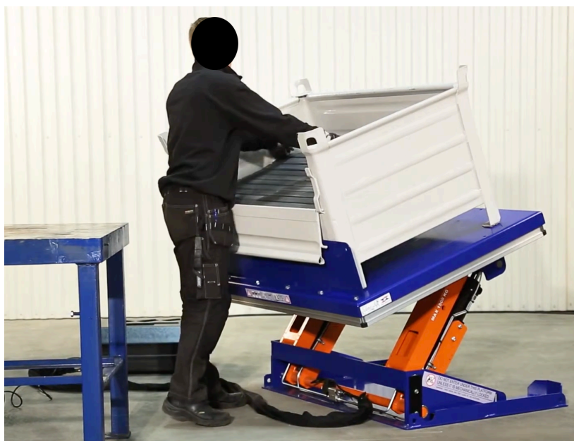
Obrázek 41 Zvedací a sklápěcí přístroj Edmolift
