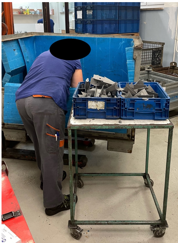
Obrázek 18 Nakládání vylisovaných dílů z gitterboxu do KLT přepravek
