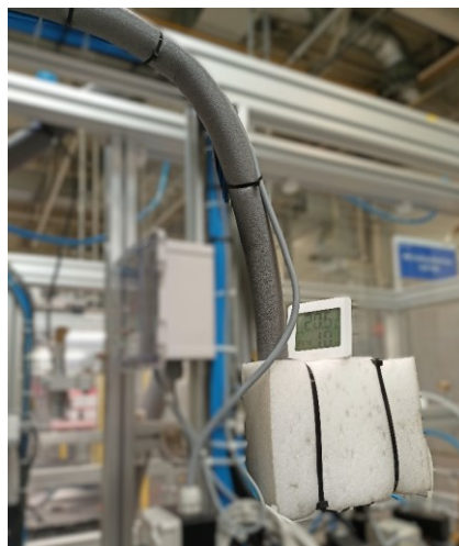
Obrázek 35 Izolace měřicího senzoru a části okruhu
