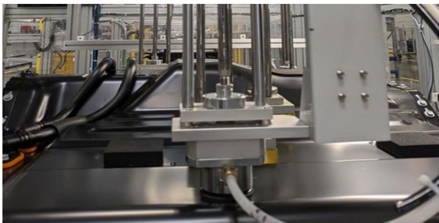
Obrázek 3 Plnicí píst obalu bateriového systému
