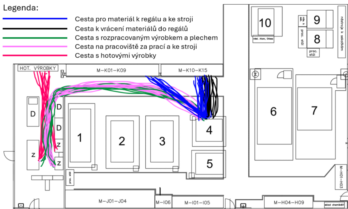
Obrázek 20 Spaghetti diagram – operátor zakázkové výroby za 8hodinovou směnu
