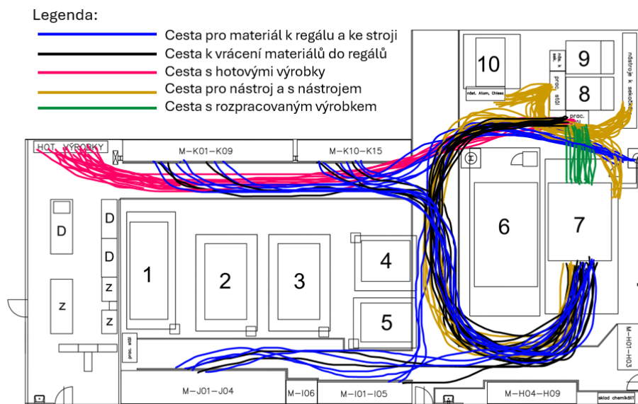
Obrázek 14 Spaghetti diagram – operátor vysekávacího poloautomatu za 8hodinovou směnu
