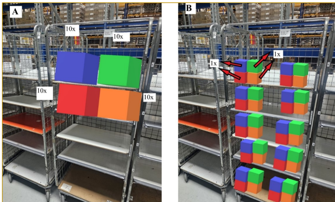
Obrázek 31 Systémová logika vychystávání položek do klece
