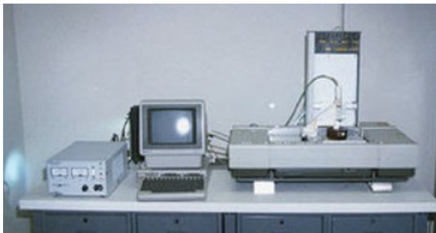
Obr. 1: První 3D tiskárna, kterou vyrobil Charles Hull [3]
