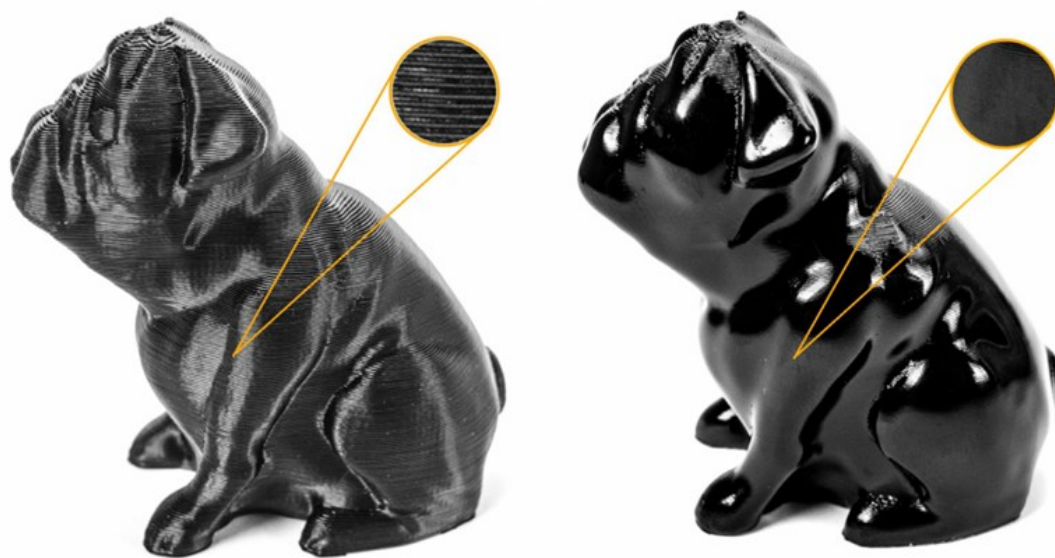
Obr. 19: Význam použití acetonových výparů [41]
