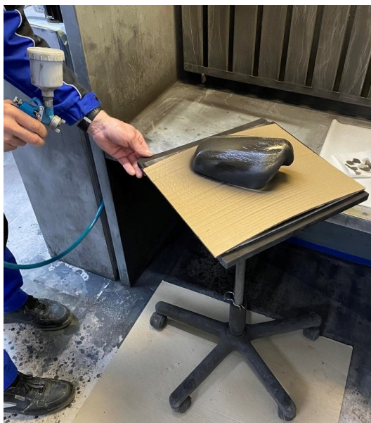
Obr. 39: Nanesení směsi plniče
