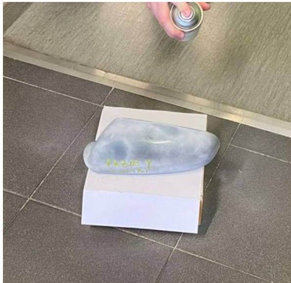
Obr. 24: Nanesení antireflexní vrstvy
