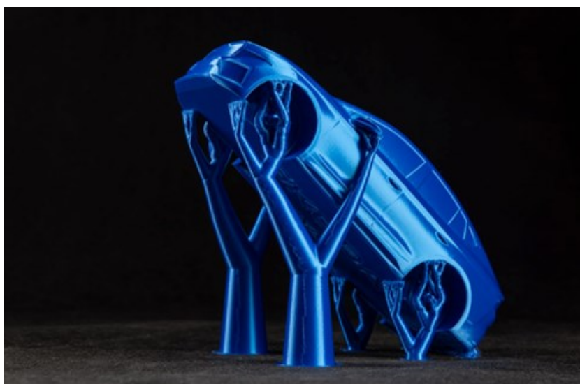
Obr. 17: Organické podpory modelu [41]
