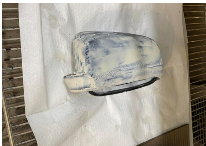
Obr. 40: Díl s naneseným tmelem umístěný v troubě
