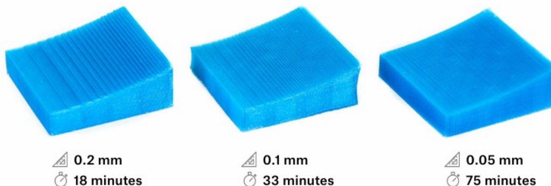
Obr. 16: Ovlivnění kvality a rychlostí tisku výškou vrstvy [41]
