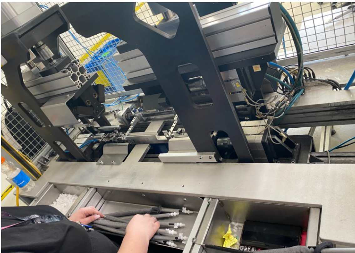
Obrázek 13 Lisování plastových koncovek
